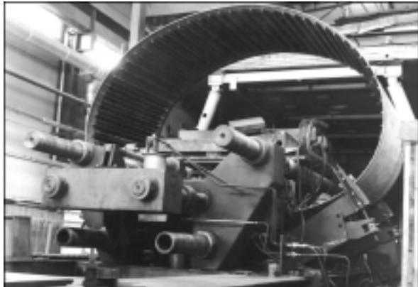
Сварная стрингерная оболочка в процессе изготовления (диаметр оболочки 4000 мм, длина 2200 мм, толщина обшивки 5 мм, 72 ребра жесткости приварены к обшивке с применением электронно-лучевой сварки)
