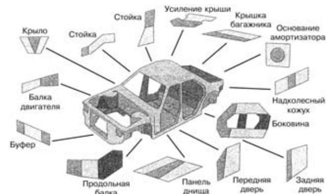
Рис. 2. Конструктивные фрагменты кузова легкового автомобиля, штампаемые из заготовок «Tailored Blanks»
