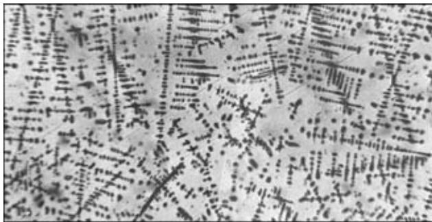
Рис. 3. Микроструктура наплавленной бронзы Бр.АЖ9-4 ( $\times 200$ )
