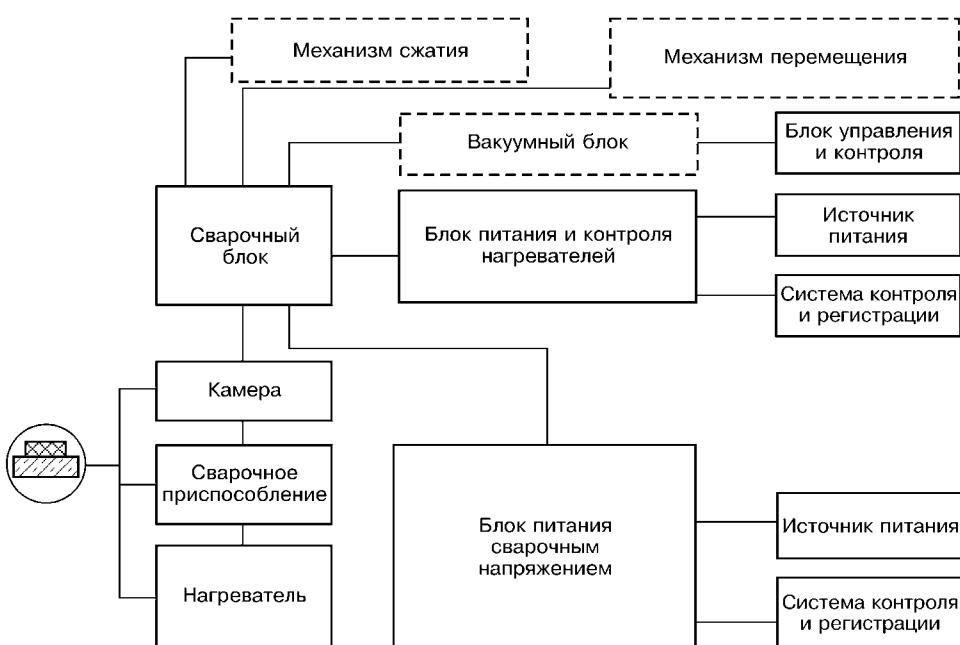
Рис. 3. Блок-схема сварочной установки для ЭХС
