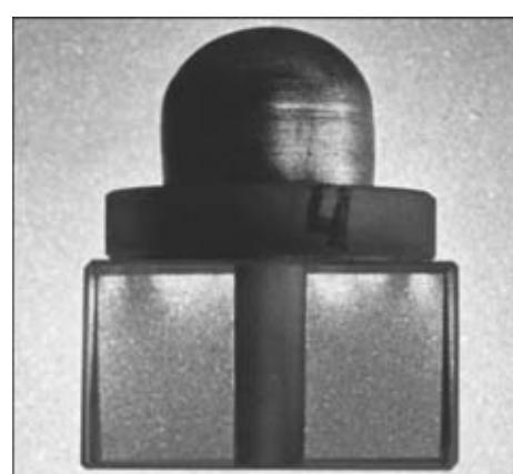
Рис. 3. Поляризационно-оптическое обследование узлов (уровень остаточных напряжений в зоне сварки 0,5 МПа)
