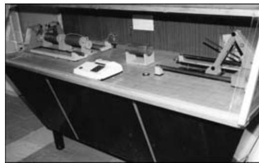
Рис. 3. Макеты роботизированного комплекса по транспортировке и сварке обечаек
