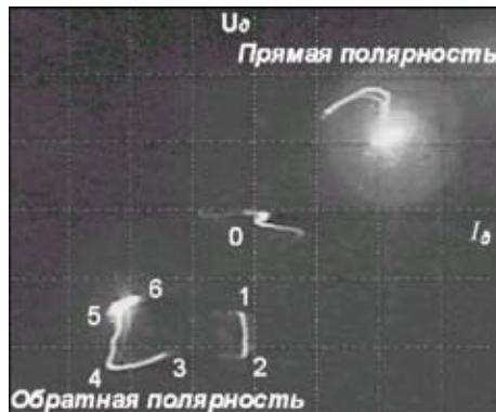
Рис. 5. Динамическая вольт-амперная характеристика дуги переменного тока прямоугольной формы при  $I_d = 100$  А,  $\tau_{\text{нр}} = 16,25$  мс и  $\tau_{\text{обр}} = 3,75$  мс (масштаб по напряжению 10 В/дел.)
