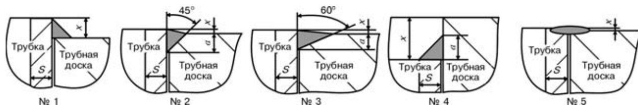
Рис. 2. Типы геометрии сочетания трубки с трубной решеткой, предусмотренные программой
