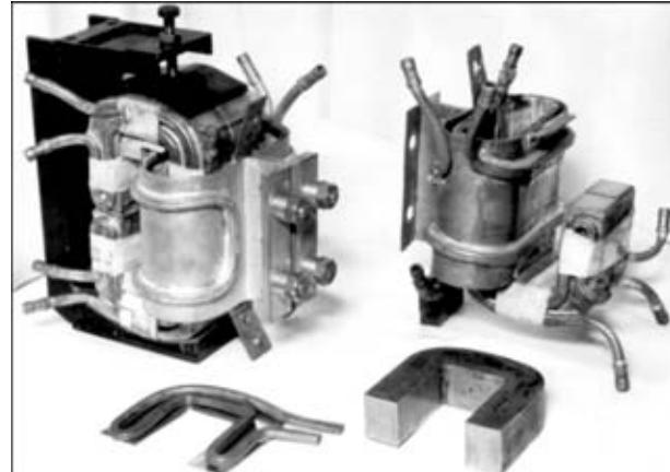
Рис. 1. Высокочастотный сварочный трансформатор малой мощности типа П-139
