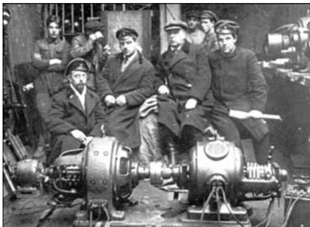
Рис. 2. Сварочный преобразователь СМ-1, созданный на заводе «Электрик» (Петроград, 1923–1924), справа налево: К. К. Хренов, В. П. Никитин и А. Е. Алексеев
