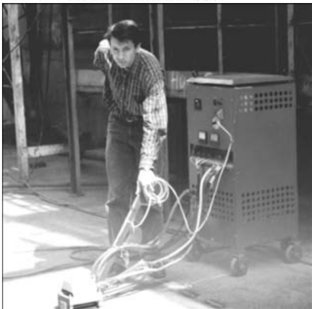
Рис. 7. Источник индукционного нагрева токами высокой частоты с нагревающим устройством
