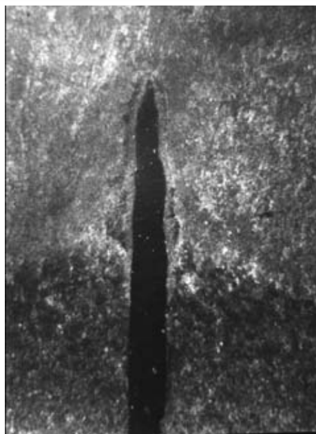
Рис. 2. Макрошлиф наплавки с тугоплавкой вставкой
