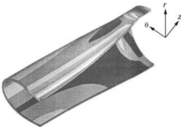
Рис. 2. Эквивалентное трехмерное распределение напряжений фон Мизеса
