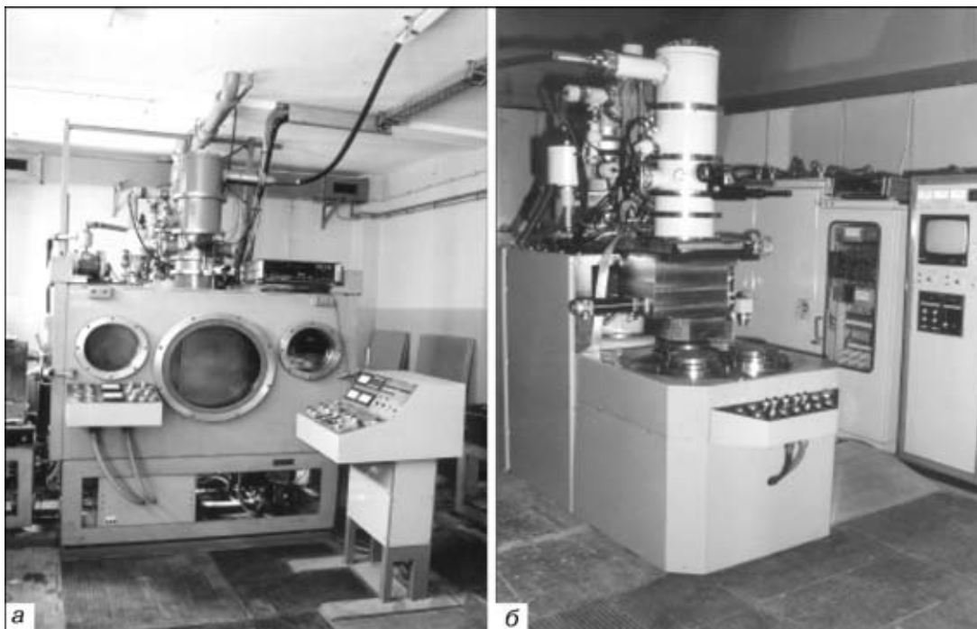
Рис. 1. Установки для электронно-лучевой сварки: а — EB Welder SE60/10 (внутренние размеры камеры 1500×1000×1000 мм; рабочее перемещение вдоль осей x , y соответственно 650 и 500 мм; поворотный вращатель с кулачковым патроном; вакуум 2 \cdot 10^{-3} гПа в камере; 2 \cdot 10^{-3} гПа в пушке; система откачки: механический насос + насос Рутса + диффузионный насос, автоматическое управление; откачка за 10 мин до 5 \cdot 10^{-3} гПа); б — EB Welder SE60/15 (такт-машина) (трехпозиционный поворотный стол; программирование параметров сварки; пушка триодного типа; прямоканальный катод 10 кВт/60 кВ; встроенная система оптического наблюдения; генератор колебаний пучка; вакуум 2 \cdot 10^{-3} гПа в камере, 2 \cdot 10^{-3} гПа в пушке; система откачки: механический насос + насос Рутса + диффузионный насос; откачка за 15 с до 2 \cdot 10^{-3} гПа)
