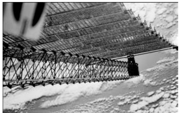
Рис. 15. Разработанная в ИЭС им. Е. О. Патона шарнирно-рычажная ферма в составе многоразовой солнечной батареи станции «Мир»
