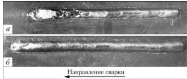
Рис. 3. Внешний вид швов при наплавке способом ИДСПЭ в случае изменения вылета электрода в пределах 10...25 мм (а, б — см. рис. 2)
