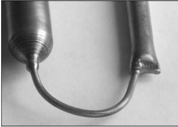
Рис. 4. Паяное соединение капилляра диаметром 2 мм с трубками диаметром 5,4 и 10 мм
