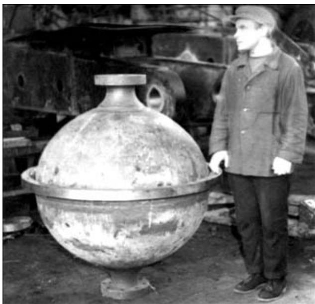
Рис. 2. Штамповарной шарообразный баллон ( P_{\text{раб}} = 35 МПа; T_{\text{раб}} = -70...100 °С; d_{\text{нар}} = 1000 мм) из биметалла 09Г2С + 0Х18Н10Т ( \delta = 100 мм)
