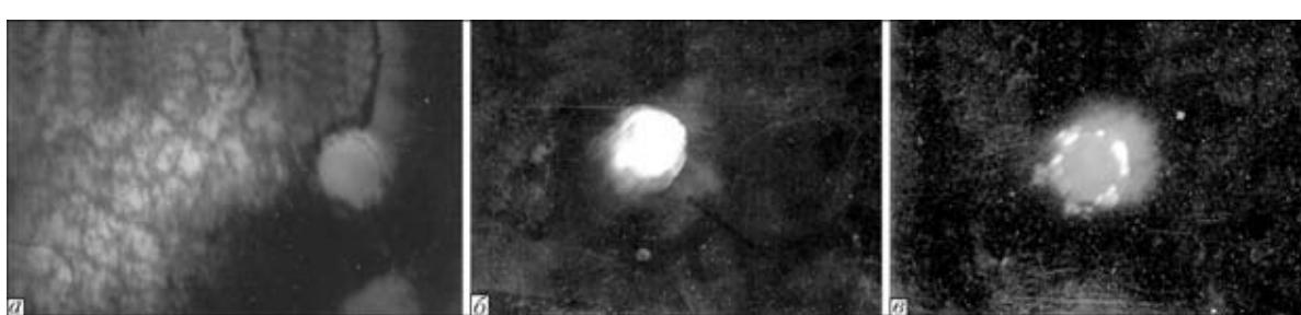
Рис. 5. Светло- (*a*) и темнопольное (*b*, *c*) изображение ( $\times 15000$ ) НВ в металле швов, выполненных сваркой под водой
