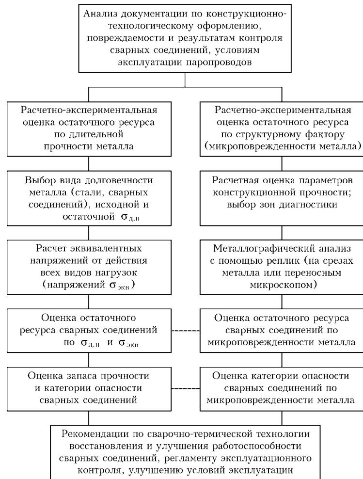
Рис. 1. Общий алгоритм расчетно-экспериментальной оценки остаточного ресурса сварных соединений паропроводов
