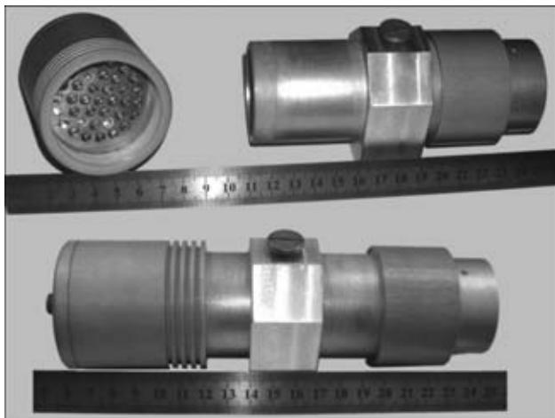
Рис. 3. Излучательный блок на основе СД-матрицы
