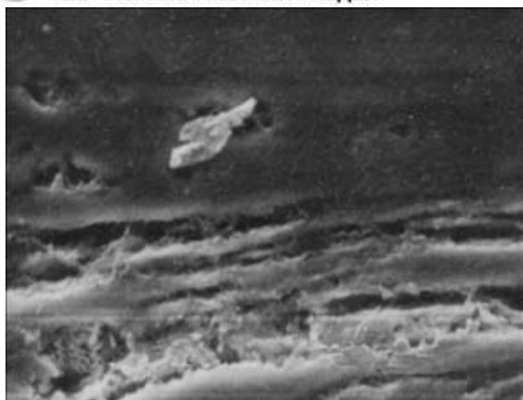
Рис. 15. Иллюстрация отрыва карбидной частицы из твердого раствора в процессе СТ, \times 7500
