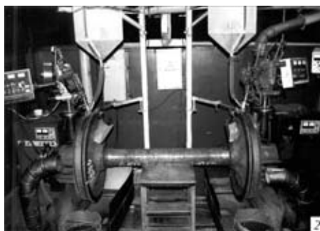
Установка для наплавки гребней УНГ-2М
