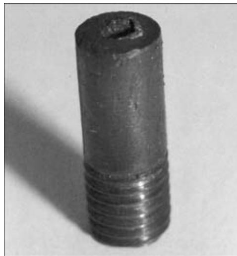
Рис. 3. Изношенный токоподводящий мундштук из экспериментального порошкового материала
