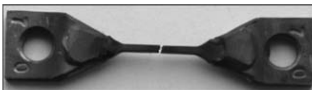
Рис. 3. Внешний вид образца из сплава ЧС-70 после высокотемпературных испытаний
