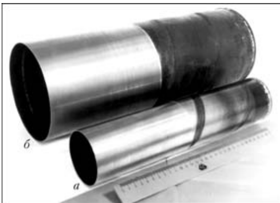
Рис. 2. Спиральношовные трубы диаметром 75×1,5 мм (а) и 152×1,5 мм (б) после токарной обработки
