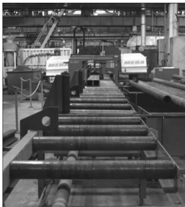
Рис. 4. Отрезная автоматическая линия с ЧПУ на базе двухколонного ленточно-пильного станка «MEBA 560 GA-3300»
