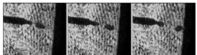
Рис. 4. Перенос электродного металла на вертикальную плоскость при комбинированном воздействии импульсного механизма подачи и импульсного источника питания [4] (получено при съемке телекамерой)
