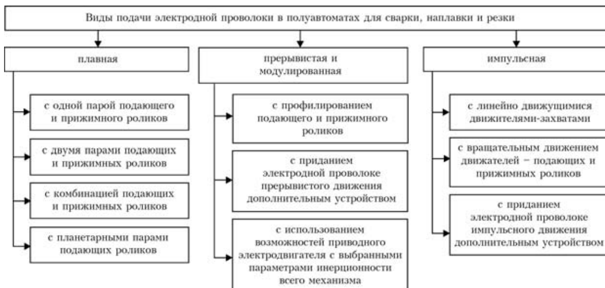
Рис. 1. Классификация основных типов механизмов подачи электродной проволоки
