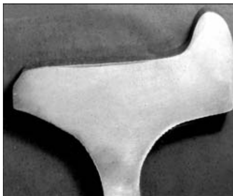
Рис. 1. Макрошлиф фрагмента колеса с изношенной поверхностью катания
