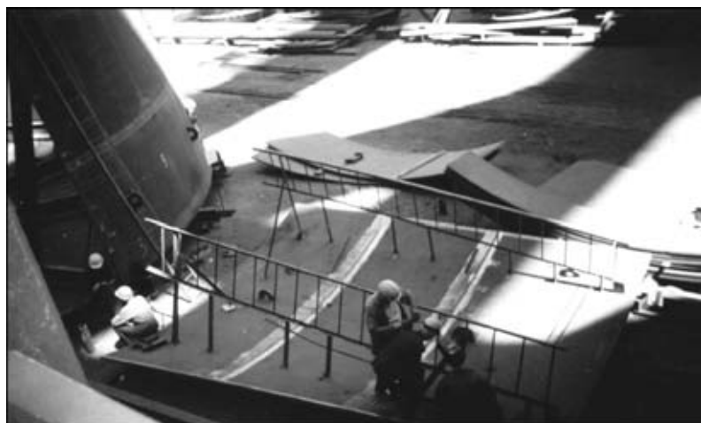
Рис. 1. Подготовка сваренных ЭШС блоков к контрольной сборке царги корпуса ДП-9 КГМК «Криворожсталь»
