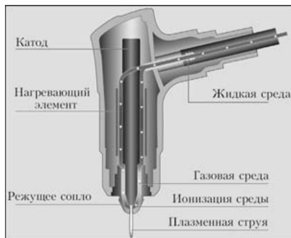
Рис. 2. Жидкость используется в качестве режущей среды в TransCut 300. Она нагревается и ионизируется в газовом резке. Результат: возможность резать металл толщиной до 10 мм, большая мобильность и меньшее количество выбросов по сравнению с системами резки сжатым воздухом
