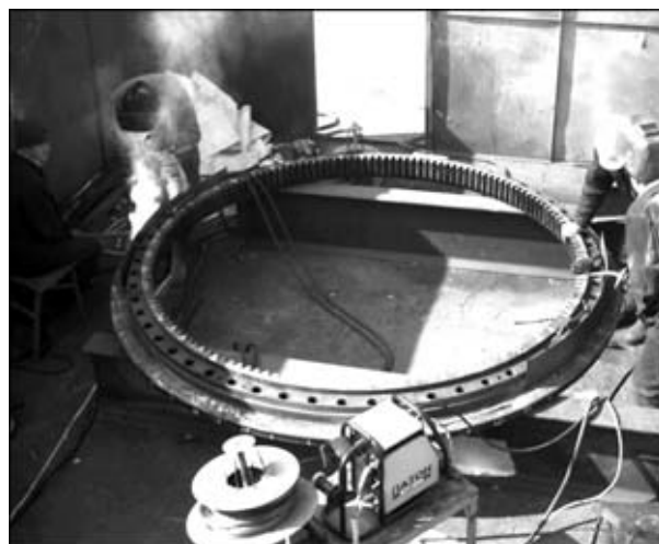
Рис. 5. Полуавтоматическая наплавка зубчатого кольца опорно-поворотного устройства крана МКТ-250
