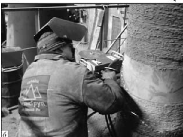
Рис. 3. Восстановление вала конусной дробилки дуговой наплавкой: а — схема восстанавливаемых поверхностей конуса; б — полуавтоматическая наплавка изношенной поверхности конуса
