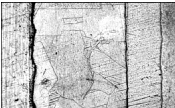
Рис.1. Микроструктура композита цирконий–ниобий–медь–сталь в исходном состоянии, X70
