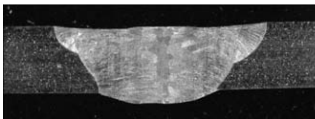
Рис. 3. Макрошлиф сварного соединения с разрезом по А-А, показывающим профиль металла шва (X6)
