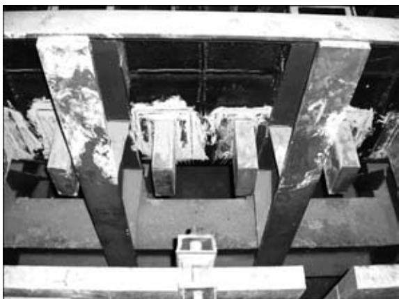
Рис. 2. Катодные стержни (блумсы) электролизера
