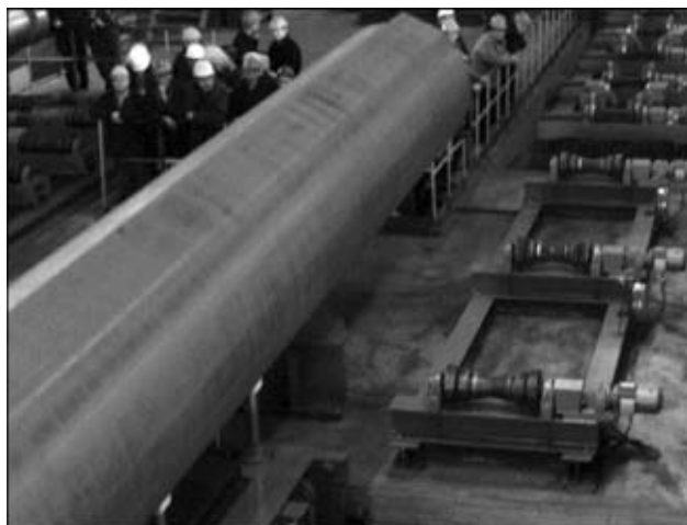
Линия одношовной сварки труб большого диаметра
