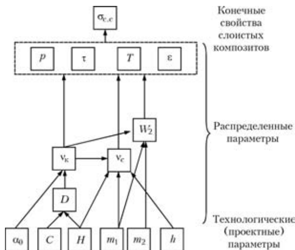
Рис. 1. Феноменологическая модель сварки взрывом двухслойного композита [1]: \alpha_0 — установочный угол между свариваемыми пластинами; C — содержание аммонита в смеси; H — высота заряда ВВ; m_1 и m_2 — единичная масса соответственно метаемой и неподвижной пластин; h — установочный (сварочный) зазор; D — скорость детонации ВВ; v_c и v_k — соответственно скорость соударения и контакта; W_2 — энергия, затрачиваемая на пластическую деформацию металла околошовной зоны (ОШЗ); p , \tau , T и \epsilon — соответственно давление, время деформирования, температура и степень пластической деформации металла в зоне соединения; \sigma_{с.с} — прочность сварного соединения
