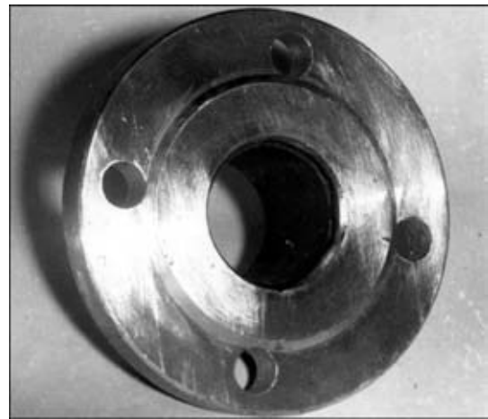
Рис. 3. Внешний вид соединения вкладной трубки с фланцем
