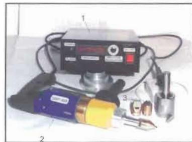
По сравнению с другими способами поверхностного пластического деформирования сварных соединений ВМП характеризуется высокой производительностью и экономичностью; компактностью и мобильностью оборудования; незначительной площадью обработки (зоны перехода от металла шва к основному металлу); возможностью обработки в произвольном пространственном положении; возможностью прогнозирования эффективности обработки; используется на стадиях производства и эксплуатации конструкций.
