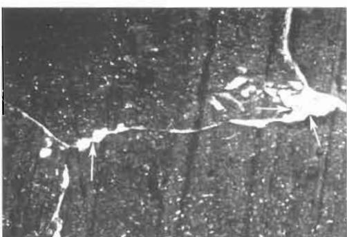
Рис. 6. Образование пор на участке неполной перекристаллизации возле коагулирующих карбидов  $M_{23}C_6$  (показано стрелками),  $\times 4500$
