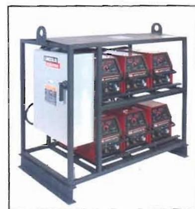
товой дуговой сварке, резке и наплавке с различными токовыми нагрузками на посту в диапазонах 200...800 и 200...1200 А.
