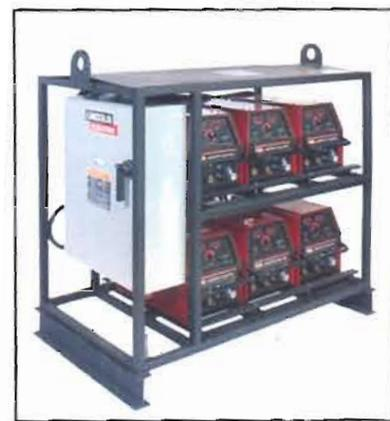
товой дуговой сварке, резке и наплавке с различными токовыми нагрузками на посту в диапазонах 200...800 и 200...1200 А.
