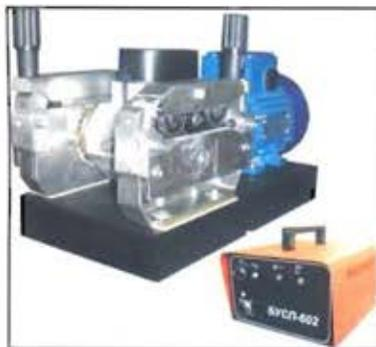
Скорость подачи электродной проволоки регулируется с помощью смены шестерен. Комплектуется блоком питания и управления с напряжением питающей сети 3x380 В.
