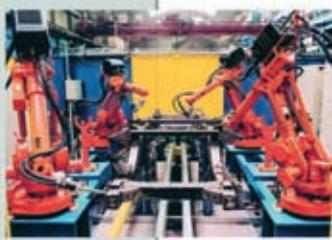
Робототехнические комплексы для дуговой сварки
