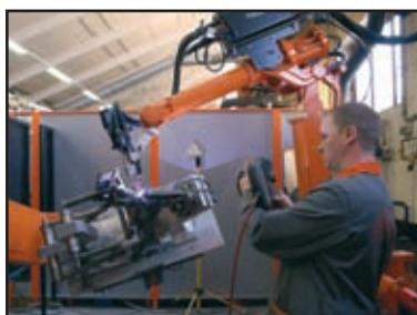
Автоматизированная ТИГ сварка с холодной подачей проволоки при изготовлении рамы мотоцикла RC8
