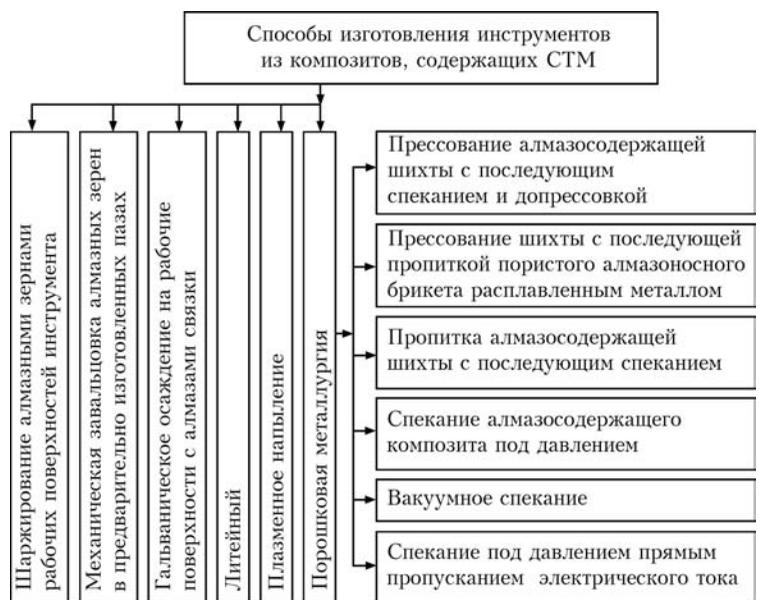
Рис. 1. Способы изготовления инструментальных композитов
