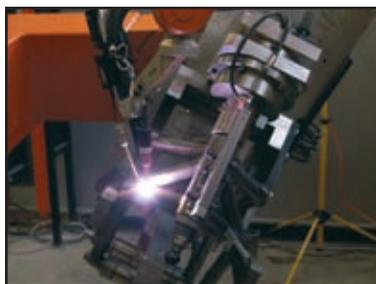
Роботизированная сварка угловых и V-образных швов с одним скосом двух кромок и зазором в 2 мм с использованием системы MagicWave 4000
