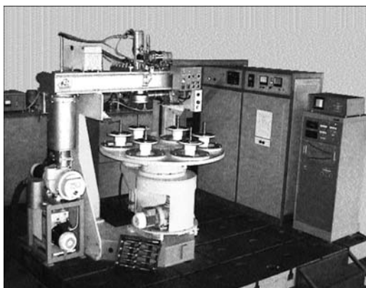
Рис. 9. Тактовая установка УЛ-157 для сварки блоков шестерен (завод АВТО-ЗАЗ, г. Мелитополь)
