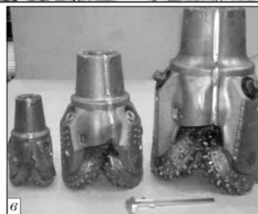
Рис. 10. Трехпушечная установка для сварки буровых долот (а), отображение стыков (б), полученное с помощью вторичных электронов на мониторе, и общий вид сваренных долот трех типоразмеров (в) (установки работают в объединении «Волгабурмаш», Самара, РФ; «Смит Тулз», Понка-Сити, США)
