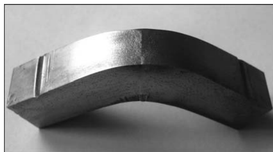
Рис. 7. Вид образца без механического надреза, вырезанного из качественного сварного соединения, полученного КСО, после испытания в условиях трехточечного ударного изгиба
