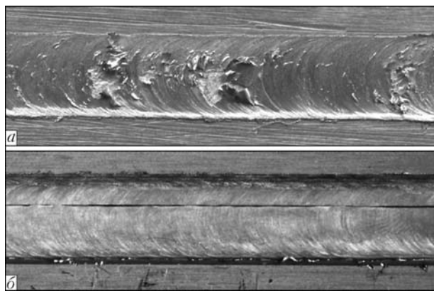
Рис. 3. Внешний вид (X2) лицевой поверхности швов, полученных СТП алюминиевого сплава 1420 толщиной 2 мм при чрезмерном (а) и недостаточном (б) погружении бурта в свариваемый металл
