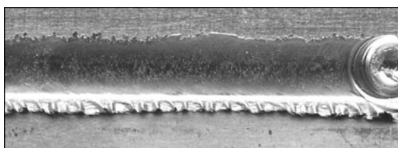
Рис. 6. Внешний вид ( \times 2 ) лицевой поверхности шва, полученного СТП сплава 1420 толщиной 2 мм при чрезмерном завышении кромки со стороны отхода инструмента
