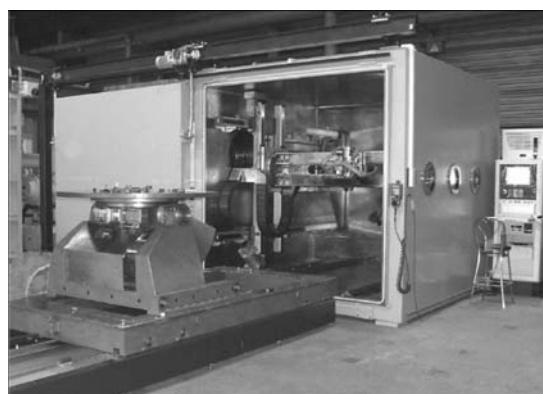
Рис. 11. Установка КЛ-132 с семикоординатной системой сварочных перемещений для изготовления изделий аэрокосмической промышленности
