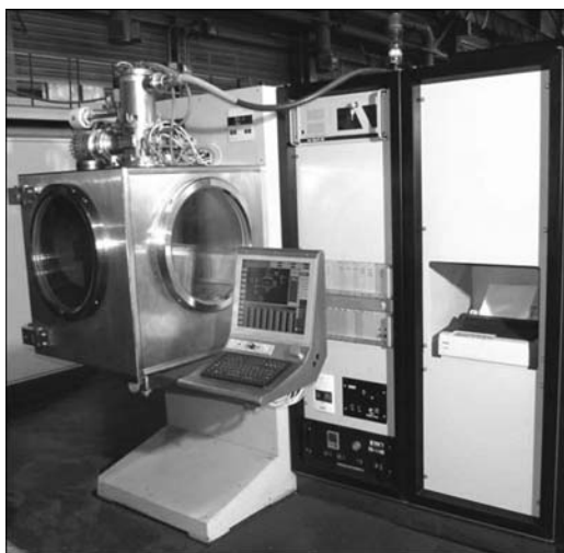
Рис. 7. Установка СВ-112 для сварки малогабаритных изделий (в промышленной эксплуатации находится семь таких установок)
