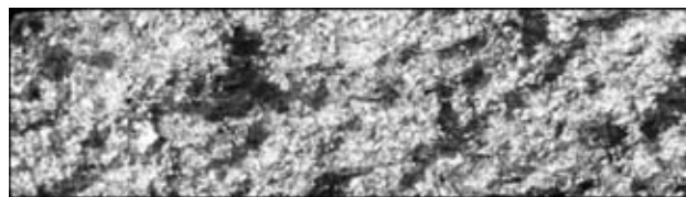
Рис. 3. Внешний вид поверхности излома образца коркового алюминиевого напыления (×10)
