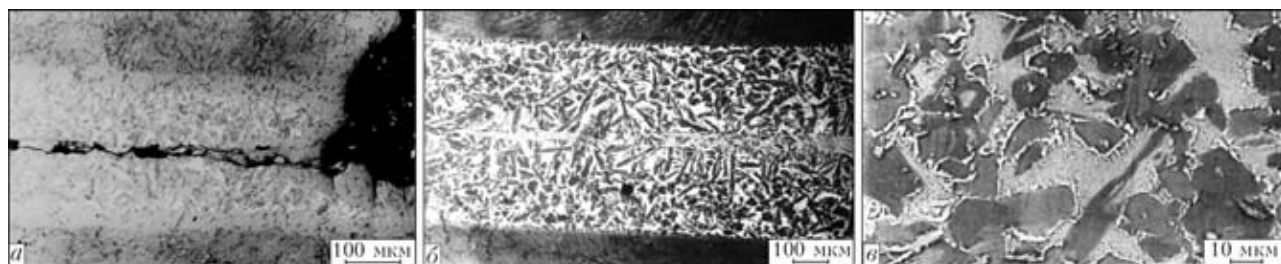
Рис. 3. Микроструктура металла паяного соединения, полученного с использованием промышленного припоя Ti–7,31Zr–20,06Cu–11,3Ni: а — трещина; б, в — эвтектика и структура центральной части шва
