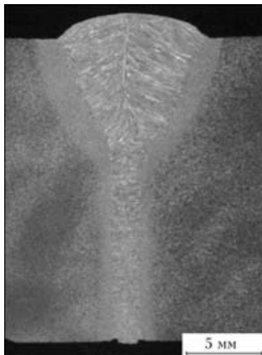
Рис. 10. Макрошлиф шва, выполненного на листах стали толщиной 20,3 мм с V-образной разделкой кромок пламенной резкой с нулевым зазором
