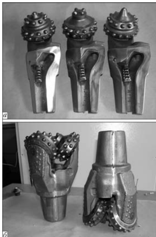
Рис. 1. Внешний вид трех элементов долота до сборки и сварки (а) и сваренного электронным пучком долота (б)
