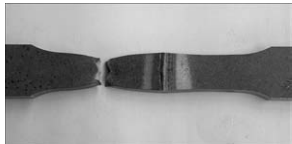
Рис. 12. Внешний вид сварного образца толщиной 15 мм после испытаний на растяжение
