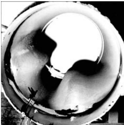
Рис. 8. Потеря устойчивости внутренней оболочки (выпячивание) во время испытания внутренним давлением
