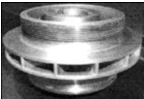
Рис. 7. Внешний вид рабочего колеса турбодетандера диаметром 300 мм
