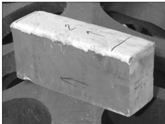
Рис. 1. Вид образца после плакирования взрывом
