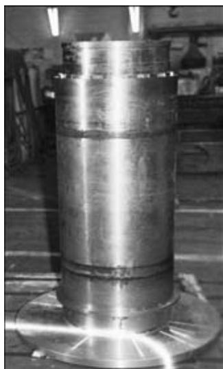
Рис. 4. Внешний вид биметаллического цилиндрического кристаллизатора
