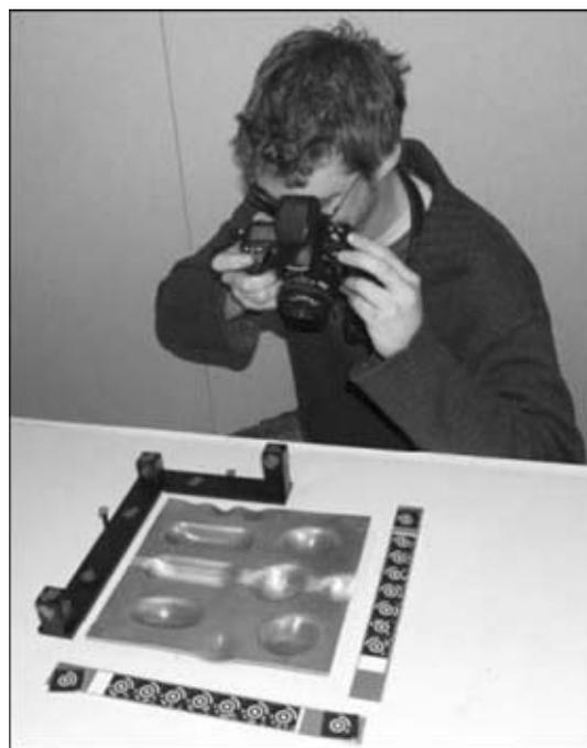
Рис. 4. Изготовление цифровых снимков для фотограмметрического анализа
