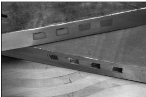
Рис. 2. Фрезерованные пластины с каналами для охлаждения водой
