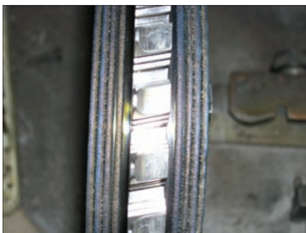
Наплавленные валики на лабиринтном диске
