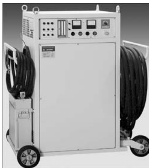
Рис. 6. Общий вид установки индукционного нагрева «ЭЛ-ТЕРМ-С УИИТ-50-2,4»
