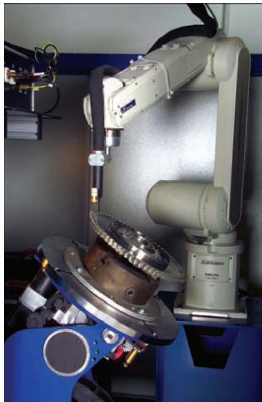
Микроплазменная роботизированная наплавка лабиринтного диска на «Мотор Сич»
