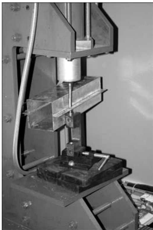
Рис. 7. Внешний вид пневмопресса для формирования механических соединений
