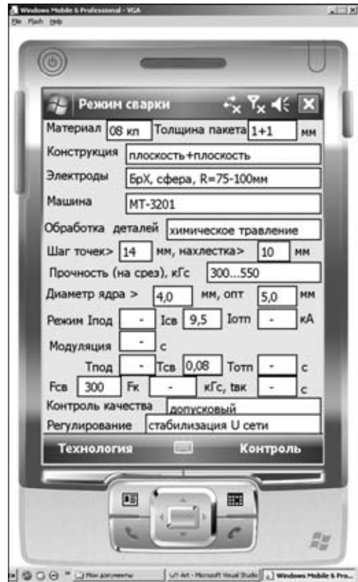
Рис. 4. Данные по технологии сварки на дисплее КПК
