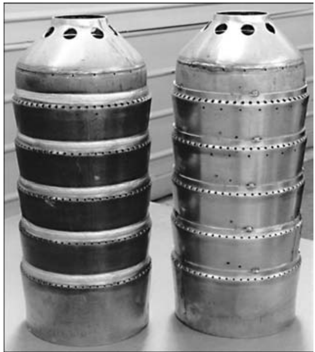
Рис. 3. Внешний вид жаровой трубы (сплав ЭИ 602, \delta = 2,5 мм) с пятью кольцевыми швами, выполненными ЭЛС
