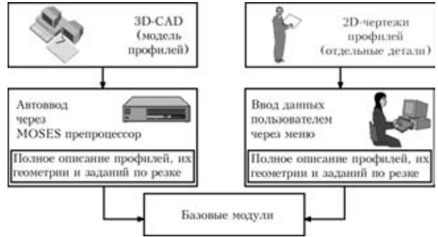
Рис. 5. Ввод и подготовка данных для генерирования программ
