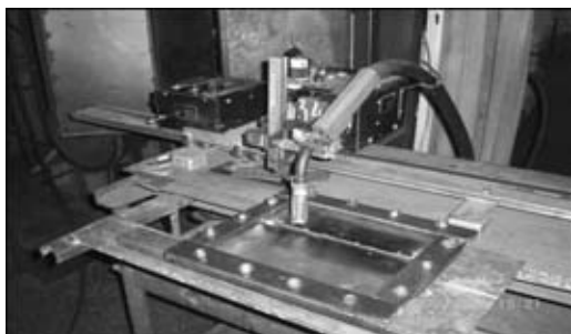
Рис. 1. Лабораторная установка для сварки образцов разнородных сталей 10X13Г18Д+09Г2С
