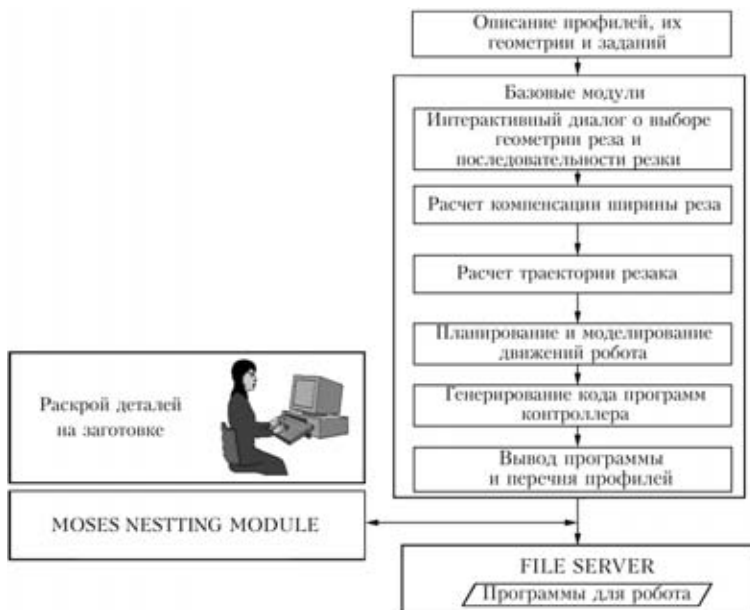
Рис. 6. Схема программы обработки профилей
