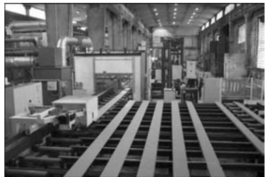
Рис. 1. Общий вид линии резки профилей с ЧПУ
