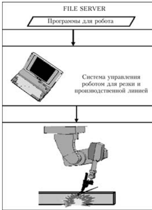
Рис. 7. Использование программ резки
