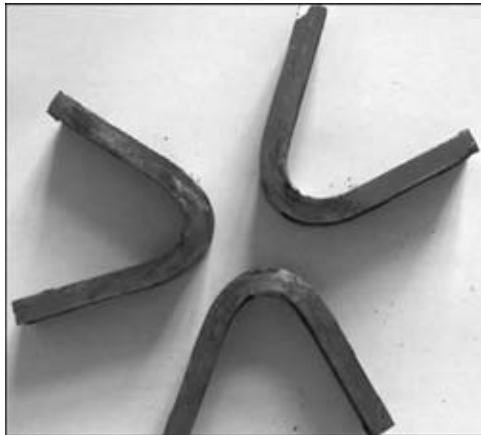
Рис. 3. Результаты испытаний сварного соединения на изгиб
