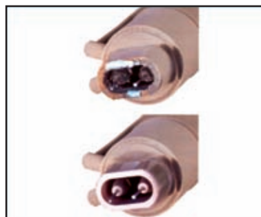
Рис. 2. Автоматизированная тандемная горелка до и после очистки
