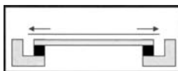
Рис. 2. Для устранения выпучивания поликарбоната необходимо увеличение зазора
