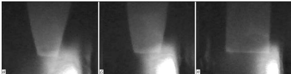
Рис. 4. Фотографии (светофильтр ИКС-5) плоскозаточенного электрода диаметром 5 мм с шириной рабочей кромки 1 (*а*), 2 (*б*) и 5 (*в*) мм и дугового промежутка в условиях СУЗ при  $I_{\text{св}} = 400$  А
