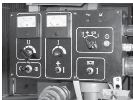
Рис. 2. Лицевая панель пульта управления аппарата А-1150К
