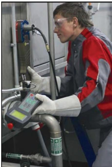
Управление системой орбитальной сварки происходит максимально интуитивно и эффективно благодаря регулировке основных параметров сварки с пульта дистанционного управления
