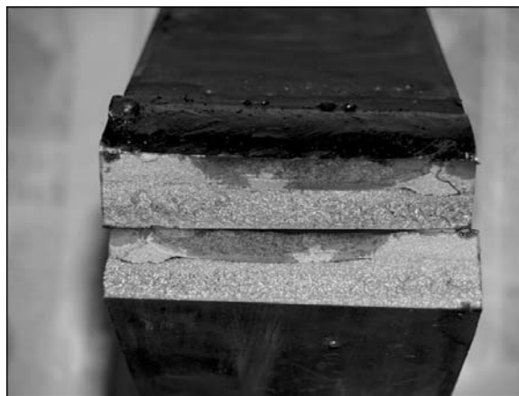
Рис. 8. Поверхность излома сварного соединения рельсовой стали с U-образной формой разделки, выполненного с предварительным подогревом до 250 °С на погонной энергии 28,5 кДж/см после циклического нагружения изгибом
