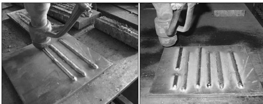
Рис. 5. Внешний вид наплавленных валиков при сварке в углекислом газе от выпрямителя с дросселем с внутренней обратной связью
