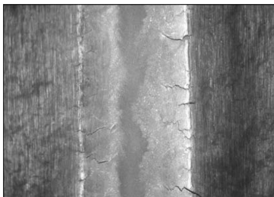
Рис. 7. Кристаллизационные трещины в швах, выполненных проволокой Inconel@52MSS ( \times 10 )
