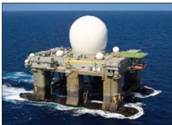
Рис. 6. Воздухоопорная конструкция антенного обтекателя на испытательной платформе ILC Dover в Мексиканском заливе [6]
