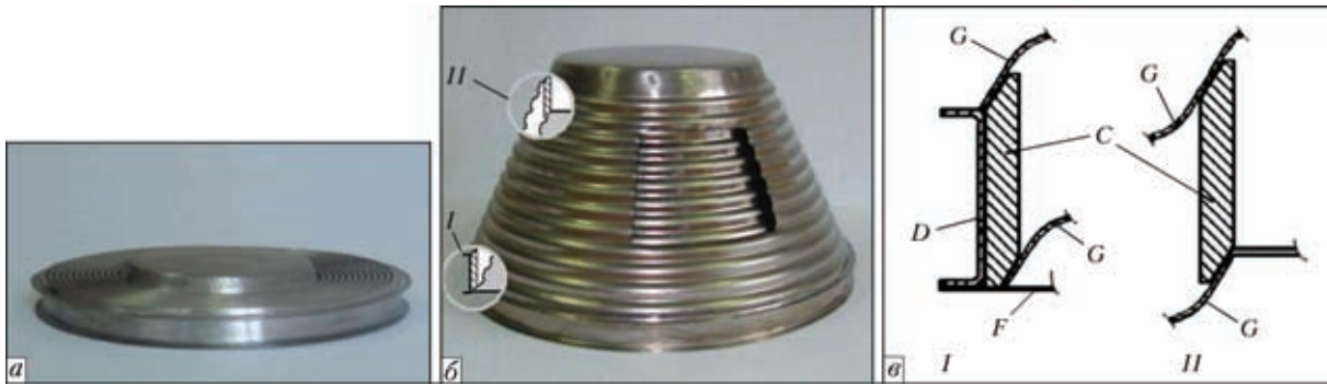
Рис. 15. Модель двухстенчатой преобразуемой конической оболочки (материал — титан ВТ1-0, толщина 0,15 мм): а — компактное состояние; б — развернутое состояние; в — осевые сечения несущих элементов (шпангоутов) I и II ; С , D — несущий и вспомогательный шпангоуты; F — днище оболочки; G — преобразуемые конические оболочки
