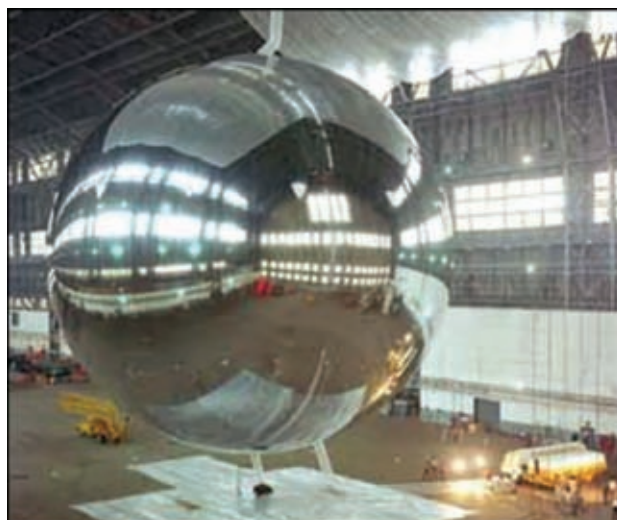
Рис. 7. Спутник наблюдения PAGEOS с массой оболочки 56 кг и диаметром 31 м [8]
