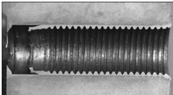
Рис. 5. Макрошлиф восстановленного резьбового отверстия
