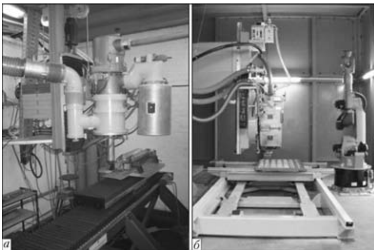
Рис. 2. Экспериментальные установки для ЭЛС в открытой атмосфере: а — Anlage Typ IGM G 150 K фирмы «Steigerwald»; б — 25-175 TU компании «PTR-Precision technology»
