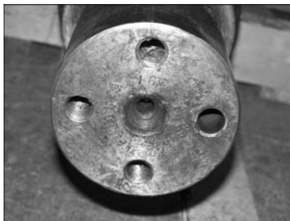
Рис. 9. Восстановленный под нарезку резьбы канал
