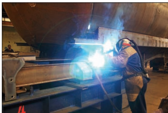
Рис. 1. Полностью цифровые источники питания от Fronius характеризуются оптимизированными функциями поджига дуги и переноса металла практически при полном отсутствии брызг
