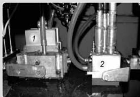
Рис. 3. Акустические блоки для контроля концевых участков труб: 1 — акустические блоки для контроля на наличие расслоений; 2 — то же, но на наличие продольных дефектов.
