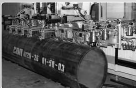
Рис. 2. Установка НК 360 для АУЗК продольных сварных швов труб
