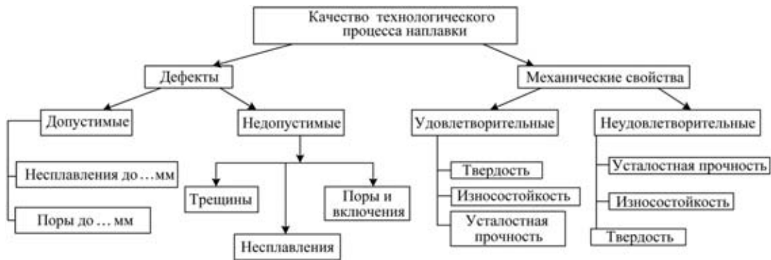
Рис. 2. Структурная схема оценки качества и надежности технологического процесса наплавки
