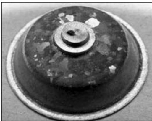
Рис. 6. Смещение ионного кратера относительно центра катода
