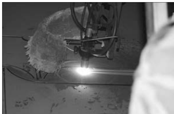
Рис. 4. Процесс резки (плазмообразующая среда воздух + вода)
