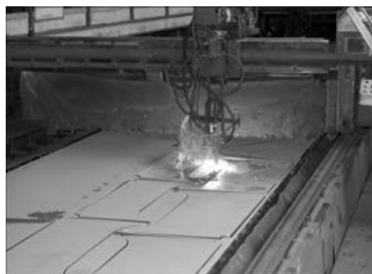
Рис. 7. Плазменная резка в плазмообразующих средах с добавлением воды
