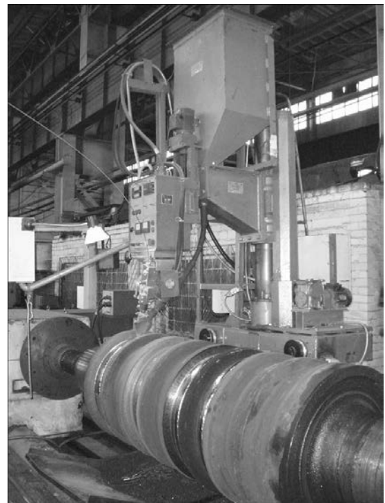
Рис. 4. Установка РМ-12 для наплавки прокатных валков
