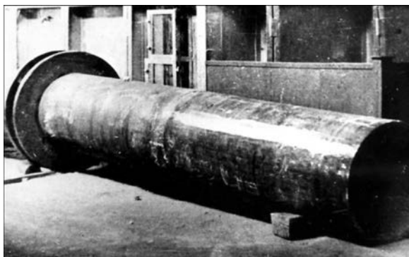
Рис. 5. Изложница кристаллизатора для вакуумной электро-дуговой выплавки титановых слитков (бронза БрХ08, толщина 40 мм)
