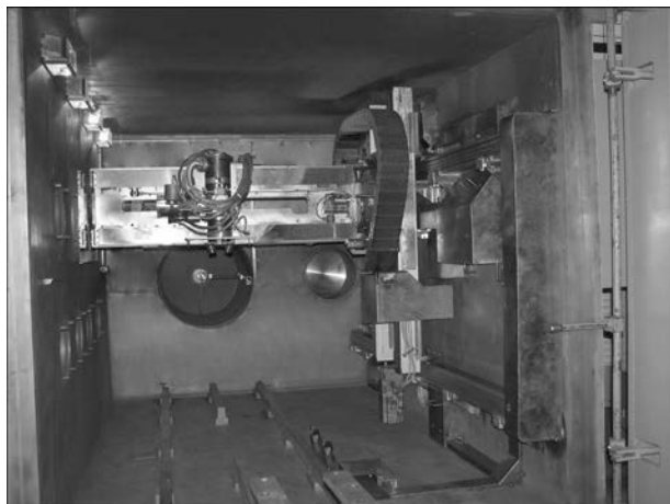
Рис. 2. Блок доработанной сварочной ЭЛП с механизмами перемещения по координатам X , Y , Z и наклоном по координате VG
