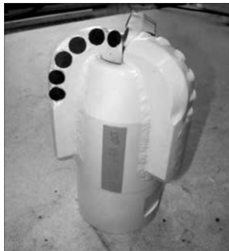
Рис. 4. Внешний вид лопасти долота с впаянными АТР
