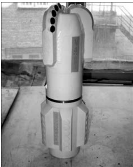
Рис. 5. Буровое долото с калибратором для поверхностного бурения скважин
