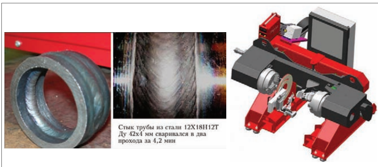
FCW «Pipe welding» — установка для сварки элементов трубопроводов.
