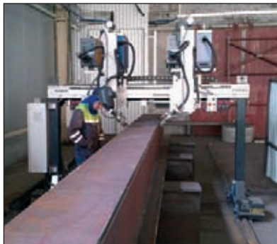
Рис. 7. Портал для сварки в защитном газе балки коробчатого сечения
