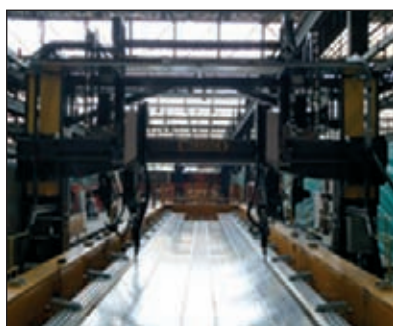
Рис. 1. Автоматический портал для сварки крыши вагона
