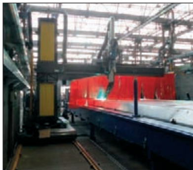
Рис. 10. Автоматическая колонна для сварки крыши вагона
