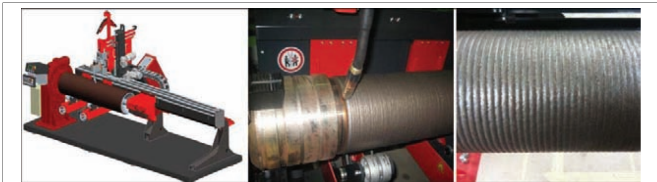
FCW «Pipe welding» — установка для сварки элементов трубопроводов.
